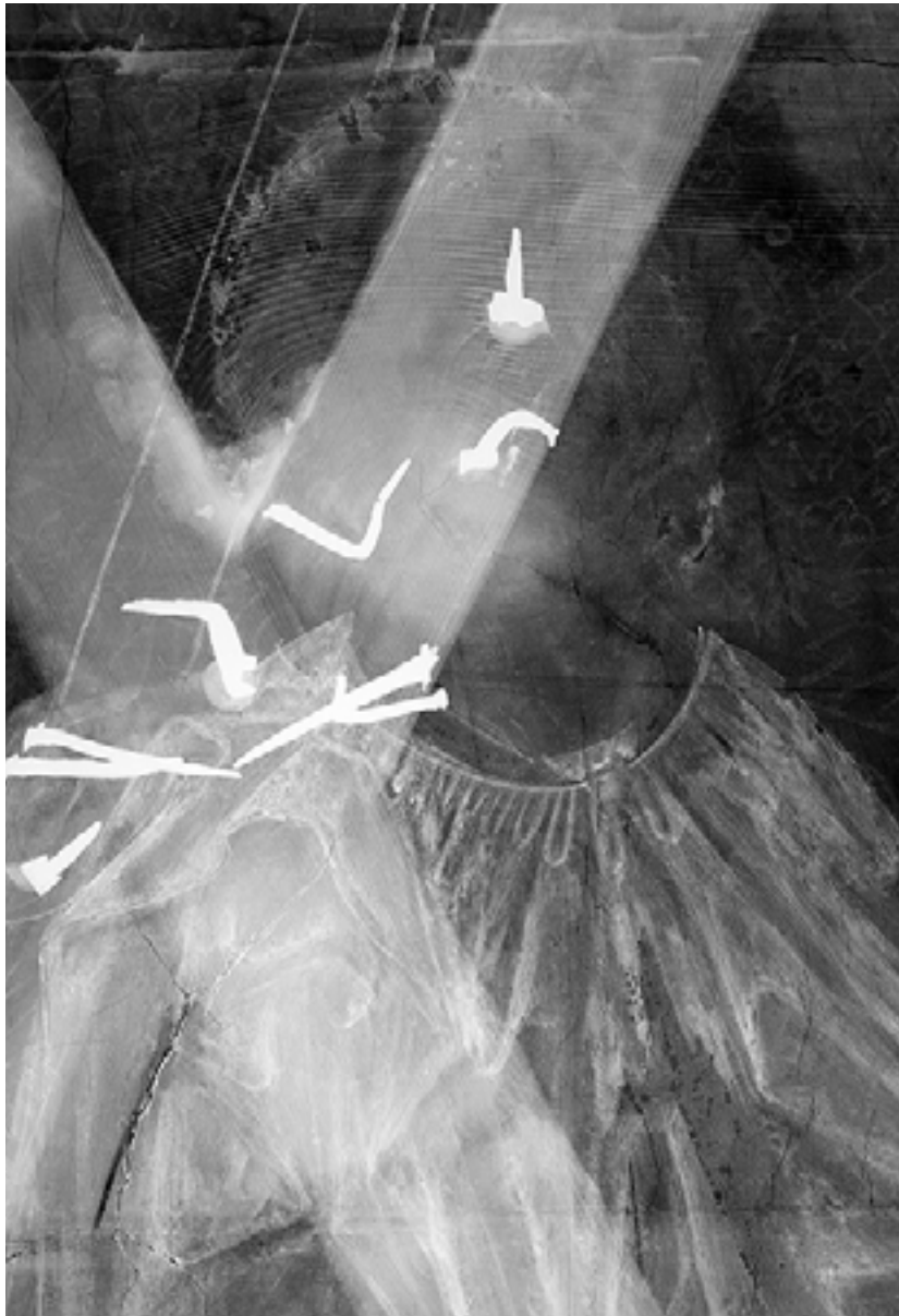
Radiografía con la efígie de Álvaro de Luna, en el que se aprecian los clavos empleados en la aplicación de las tablas crucetas.
